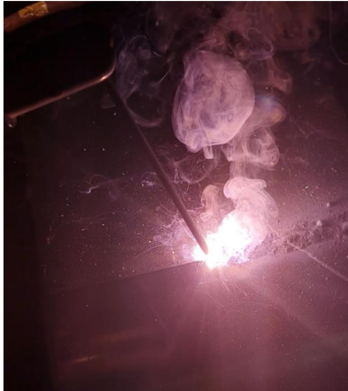
Figura 38 - Soldagem dos corpos de prova
