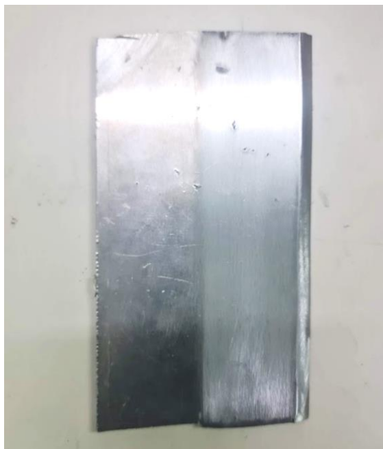
Figura 19 - Comparação peça intacta vs peça lixada
