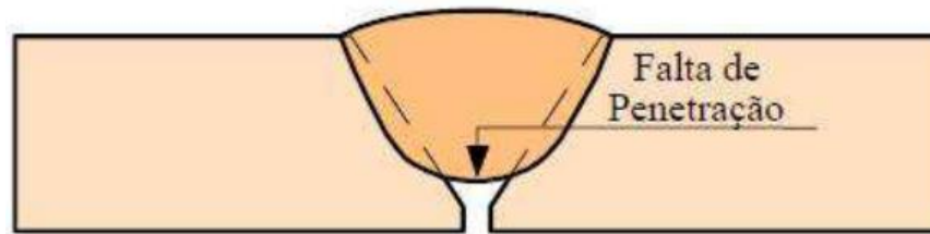
Figura 11 - Falta de penetração
