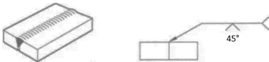
Figura 21 - Representação do cordão de solda Solda Topo
