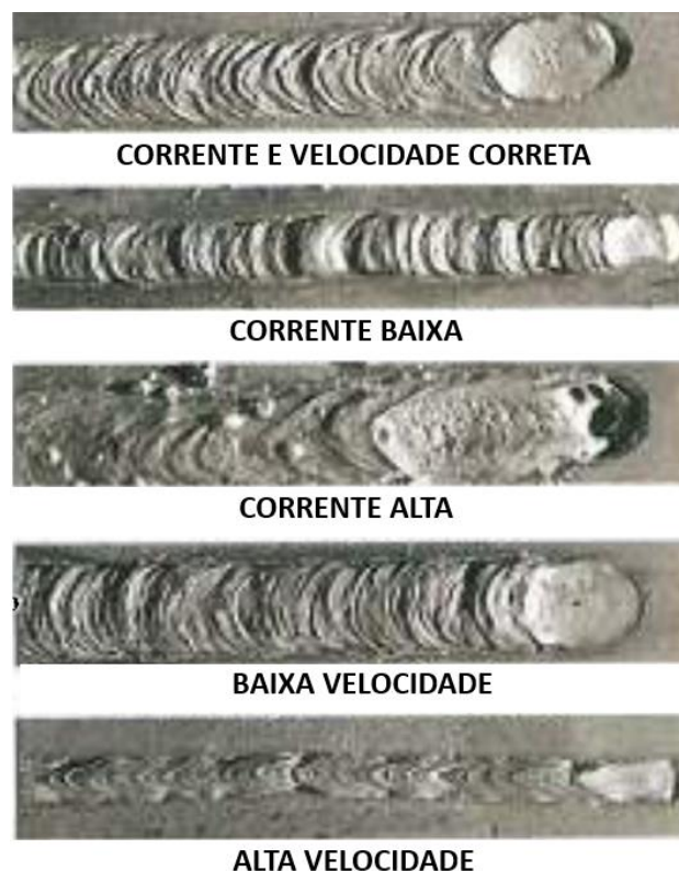
Figura 37 - Ajuste da corrente e velocidade de soldagem
