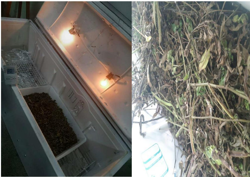
Figura 5: A) Estufa adaptada na estrutura de geladeira. B) Material vegetal de S. occidentalis em processo de secagem na estufa.
