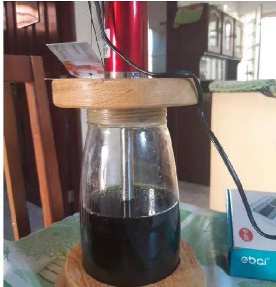
Figura 11: Extração com folhas de S. occidentalis em tanque agitado. Fonte: O Autor
