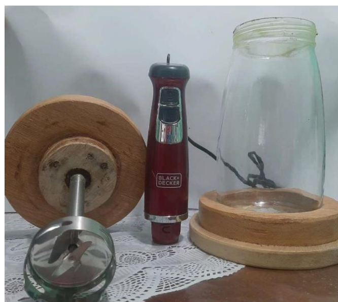
Figura 10: Reator mecânico de rotação para extração. Fonte: O Autor
