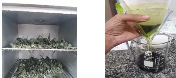
Figura 4. Secagem das folhas em estufa a seco e filtragem do extrato obtido após 72h de condição estacionária.
