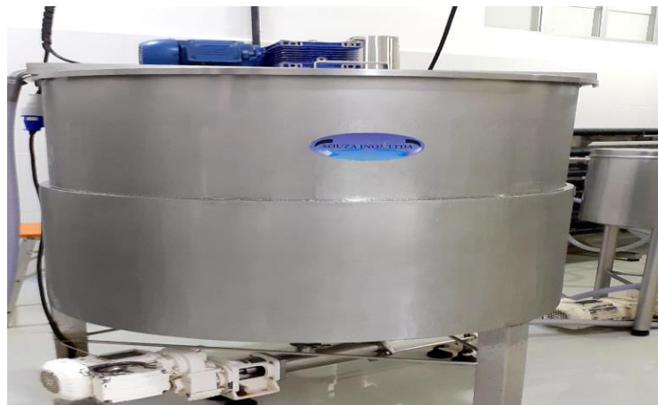
Figura 05: Tanque de Homogeneização 1.000L
