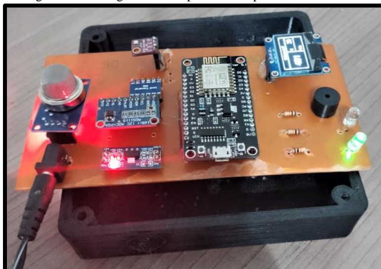
Figura 23 - Soldagem dos componentes na placa módulo sensor.
