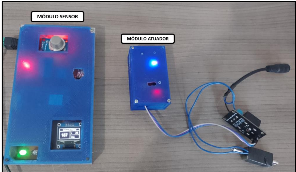
Figura 57 - Protótipo do dispositivo para detecção e prevenção de incêndios em ambientes residenciais.
