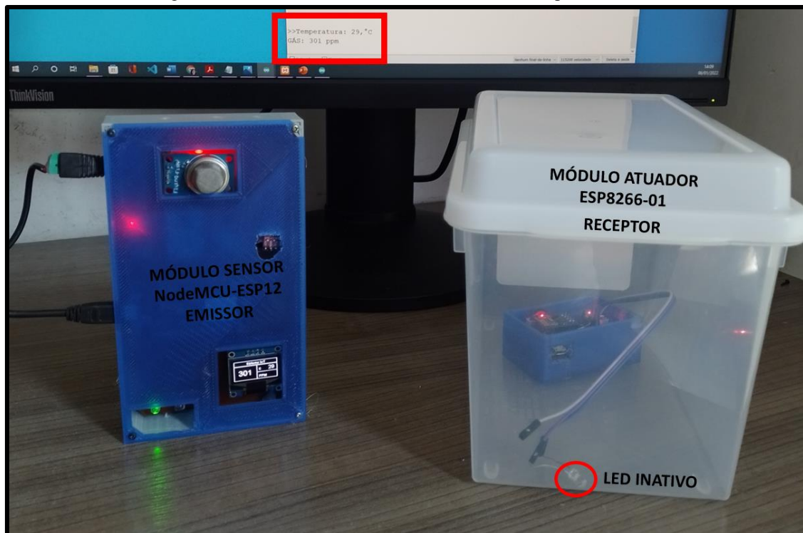
Figura 32 - Cenário de teste de envio de dados entre placas ESP's.
