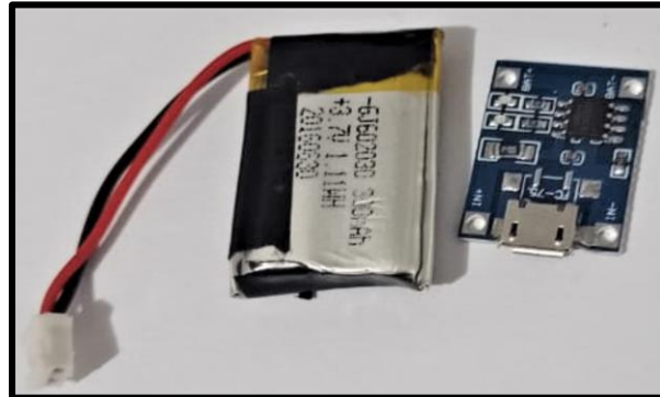
Figura 28 - Módulo carregador de bateria de lítio.
