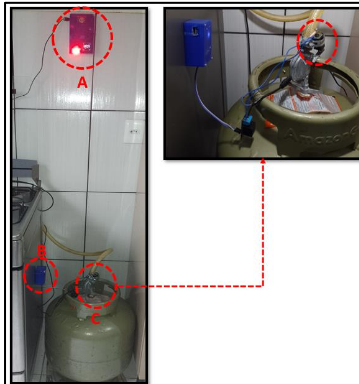
Figura 50 - Cenário de teste de integração do protótipo de sistema.
