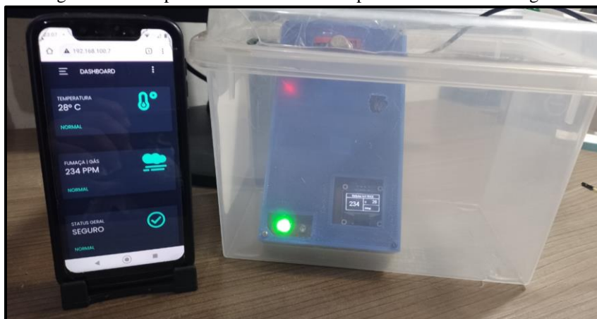
Figura 43 - Recipiente descontaminado representando o status seguro.
