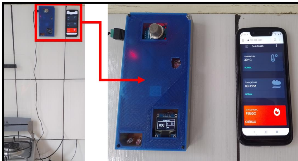
Figura 48 - Status crítico dos testes de vazamento de gases inflamáveis.
