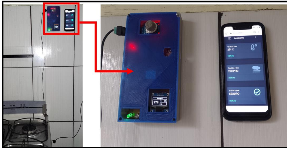
Figura 47 - Status seguro do teste de vazamento de gás inflamável.
