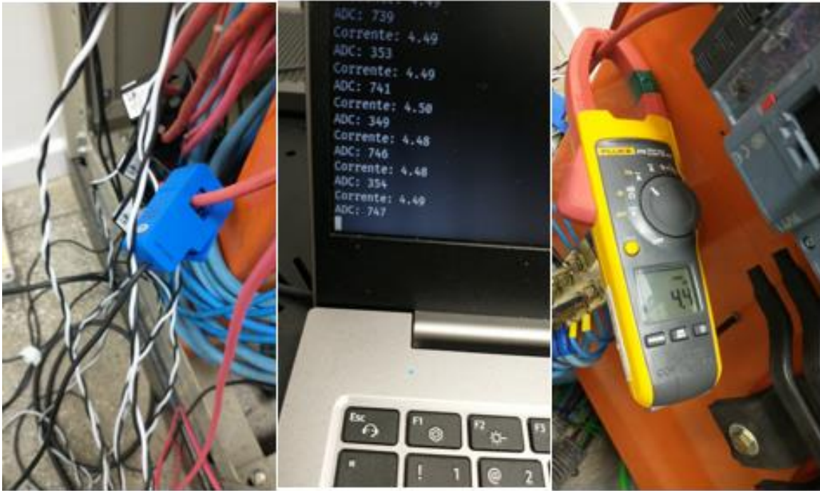
Figura 23 - Teste comparando valor medido e valor real de corrente.
