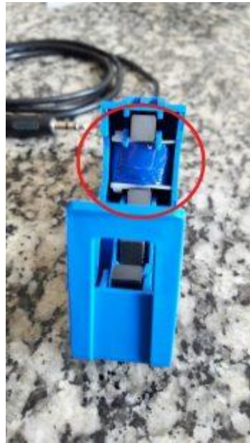
Figura 12 - Bobina interna do sensor de corrente SCT013.
