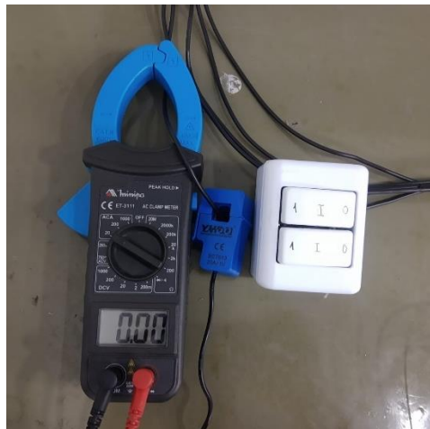
Figura 29 - Sensor de corrente montado junto ao multímetro.
