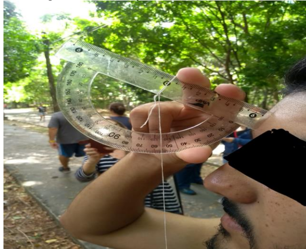
Figura 12: Utilização do Teodolito caseiro
