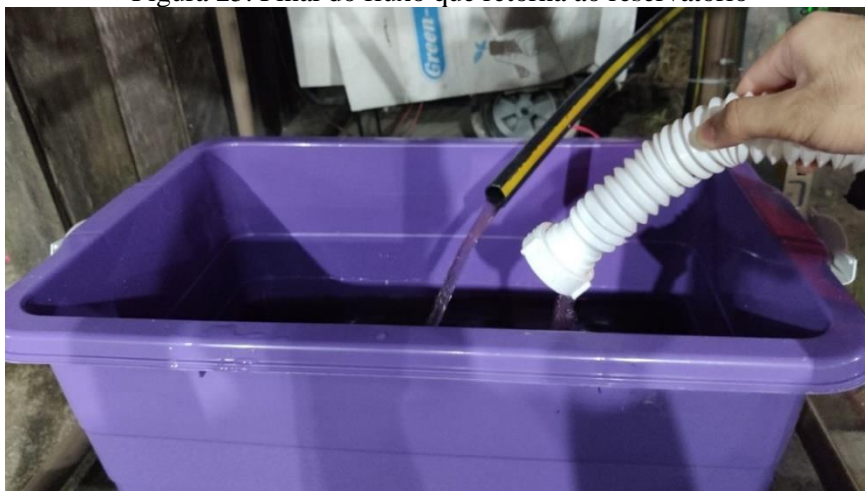
Figura 25. Final do fluxo que retorna ao reservatório
