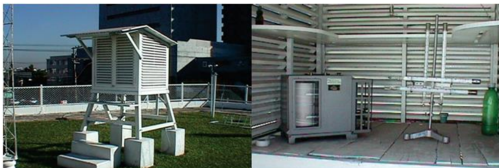
Figura 1 - Abrigo meteorológico, fechado e aberto.
