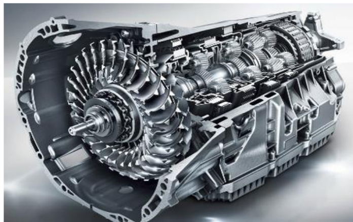
Figura 7. Caixa de velocidades automática
