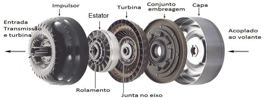
Figura 9. Esquema de um conversor de torque
