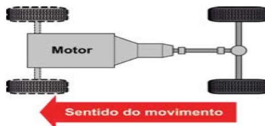
Figura 1. Sistema de Transmissão Logintudinal
