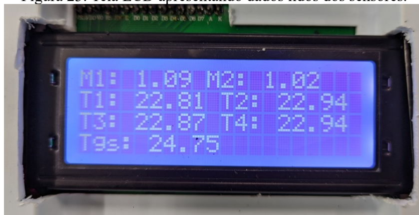
Figura 23: Tela LCD apresentando dados lidos dos sensores.
