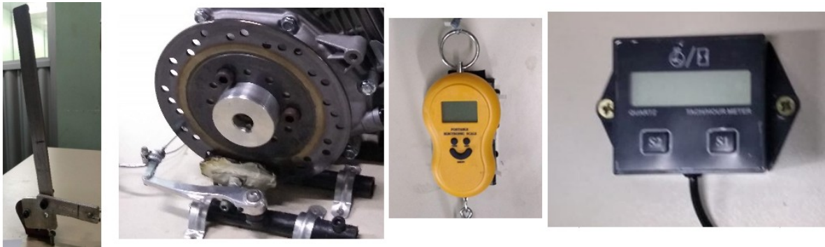
Figura 12: Da esquerda para a direita: Alavanca, sistema de frenagem, balança e tacômetro.
