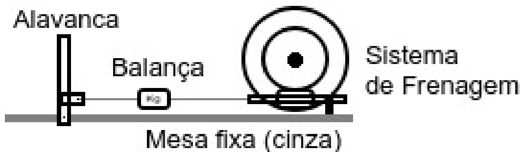
Figura 13: Esboço do sistema dinamométrico mecânico.
