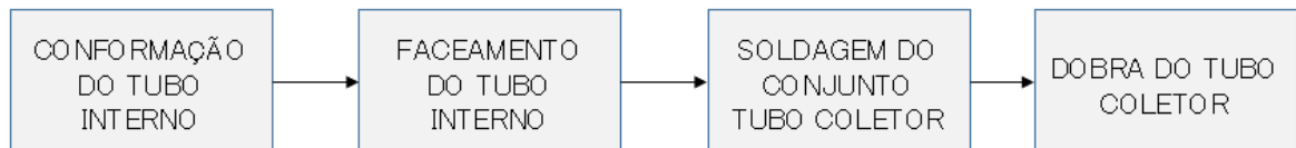
Figura 9 – Fluxo de fabricação do tubo coletor
