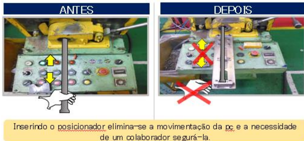
Figura 23 – Instalação do dispositivo no processo
