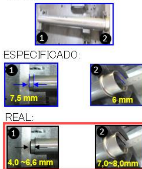
Figura 13 – Ajuste das peças para o processo de soldagem
