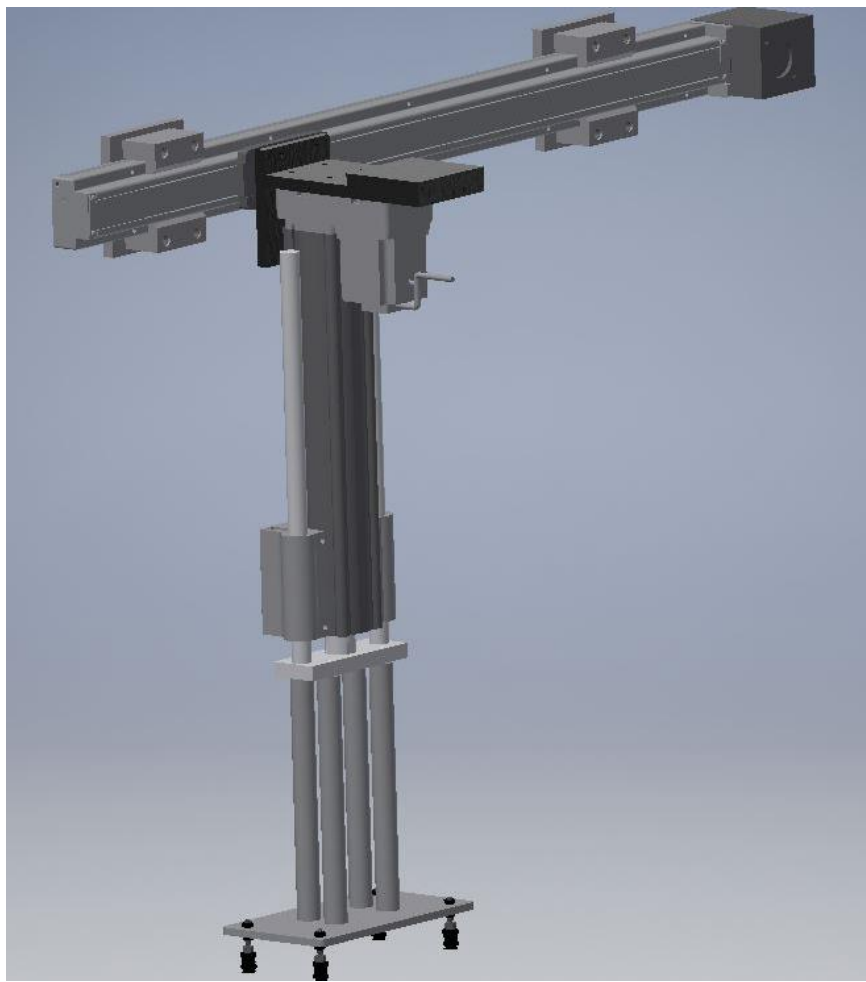
Figura 7 – Projeto Manipulador Alimentador da esteira de impressão.
