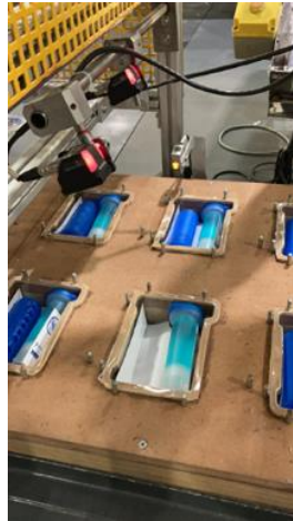
Figura 38 - Posicionamento de Inspeção da Câmera Keyence
