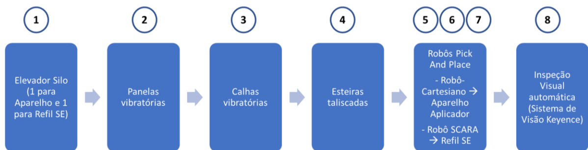
Figura 39 – Fluxograma resumido do sistema Pick and Place e de Inspeção
