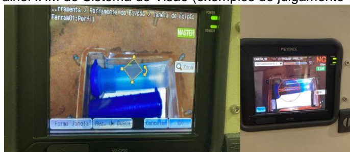
Figura 37 - Painel IHM do Sistema de Visão (exemplos de julgamento OK e Não OK)
