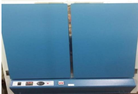
Figura 5: Estufa de circulação forçada. Fonte: MACÊDO, 2018.
