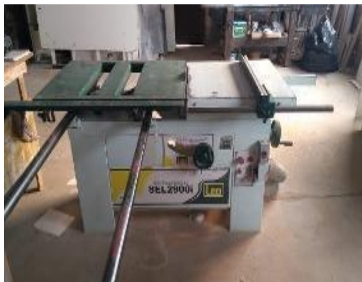
Figura 12: Esquadrejadeira Fonte: RODRIGUES, 2016
