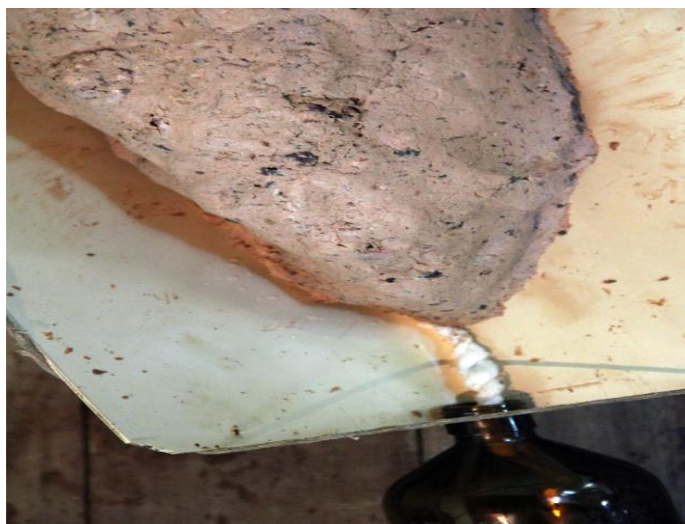
Figura 19: Massa de amêndoa em forma de pão e com chumaço de algodão na ponta do estilador para filtrar e direcionar o escoamento do óleo até o vidro.
