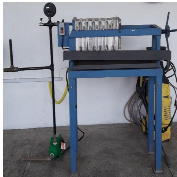
Figura 23: Filtro elétrico para a filtragem do óleo de andiroba. Fonte: autora.
