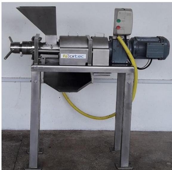
Figura 22: Prensa elétrica Ecartec para a extração do óleo de andiroba. Fonte: autora.
