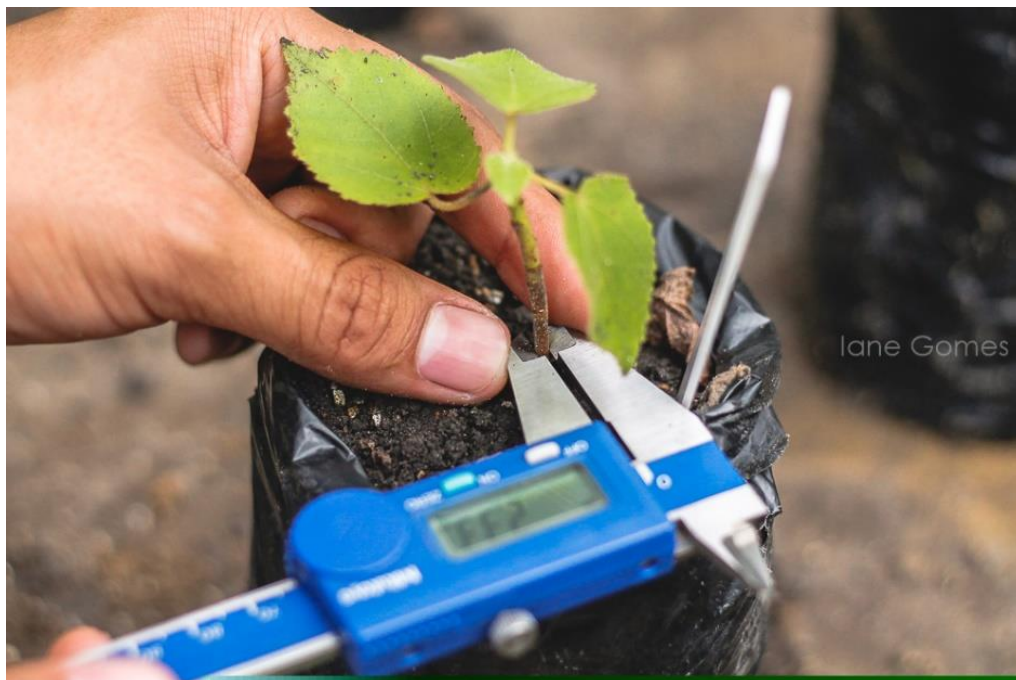
Figura 2 – Aferição do diâmetro do coleto de muda de Ochroma pyramidale com auxílio do paquímetro digital
