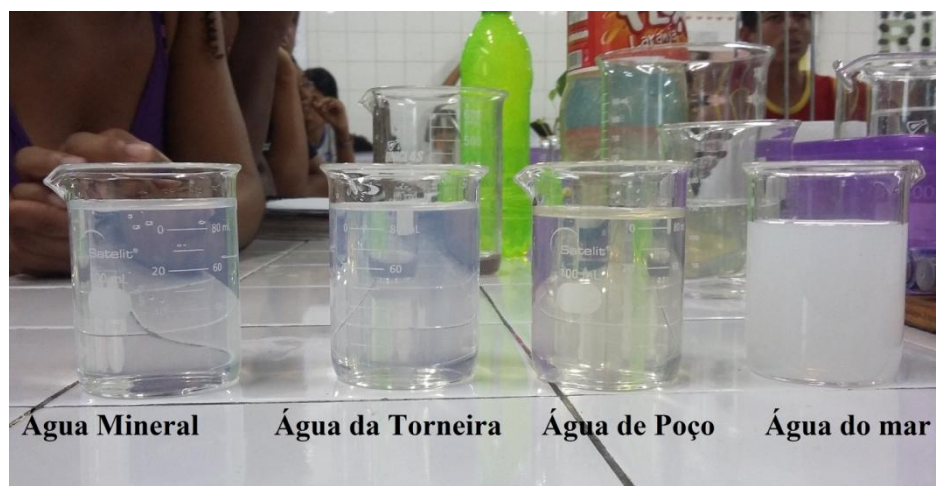
Figura 4: Determinação de íons cloreto (Fonte: Autores)
