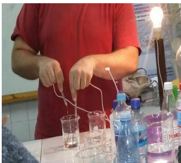
Figura 5: Determinação da condutividade na água do mar (Fonte: Autores)
