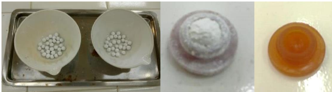
Figura 1 - A esquerda esferas de \text{TiO}_2 produzidas a 500^\circ\text{C} e a direita o molde de silicone utilizado para moldagem.
