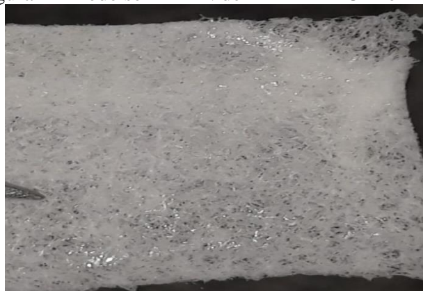
Figura 1 – Rede semi- IPN de PHEMA-PCL formada
