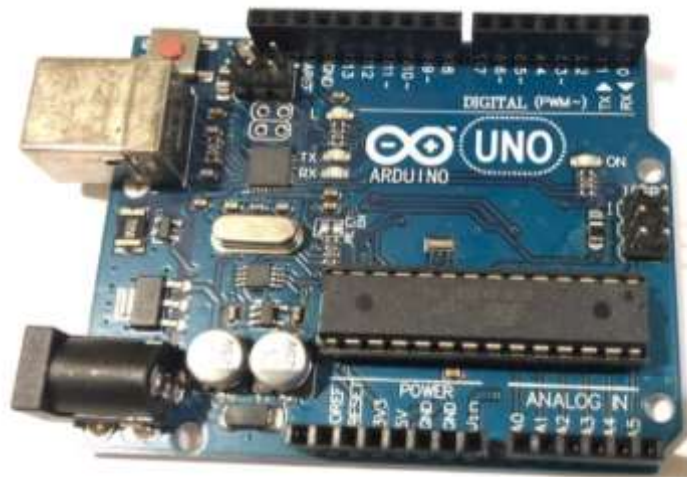
Figura 3 – Placa Arduino Uno
