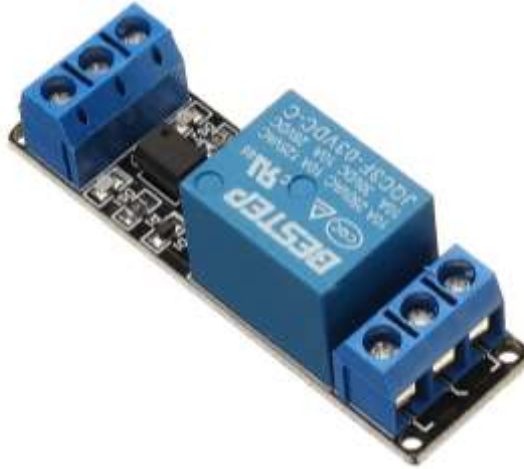
Figura 11 – Módulo Relé 5 V
