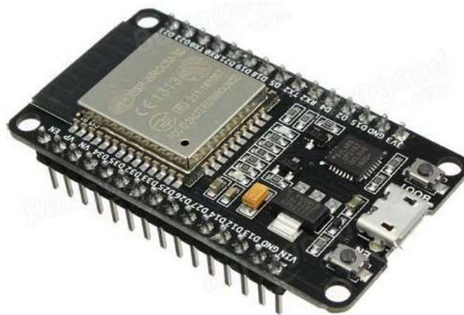
Figura 5 – DOIT ESP32 DevKit V1
