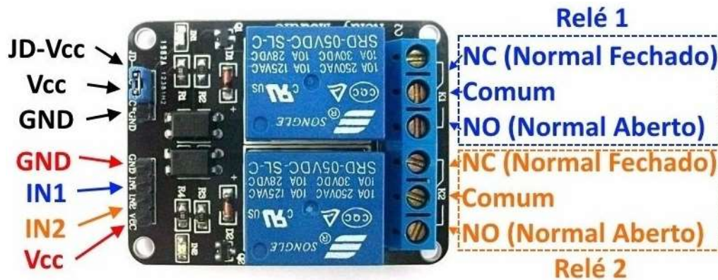
Figura 24 – Pinagem do módulo relé de 2 canais
