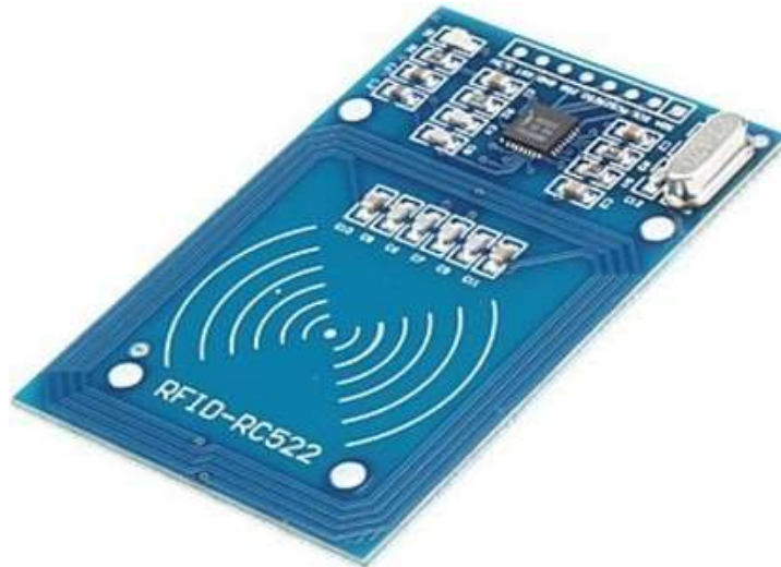
Figura 17 – Leitor RFID MFRC522
