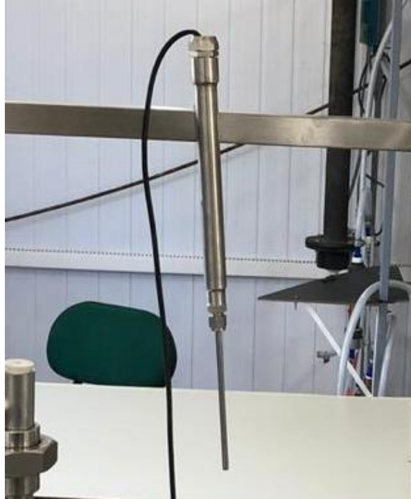
Figura 20 - Sensor de Temperatura Pt 100 empregado
