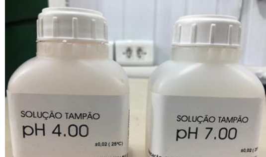
Figura 11 - Soluções tampão utilizadas para calibração
