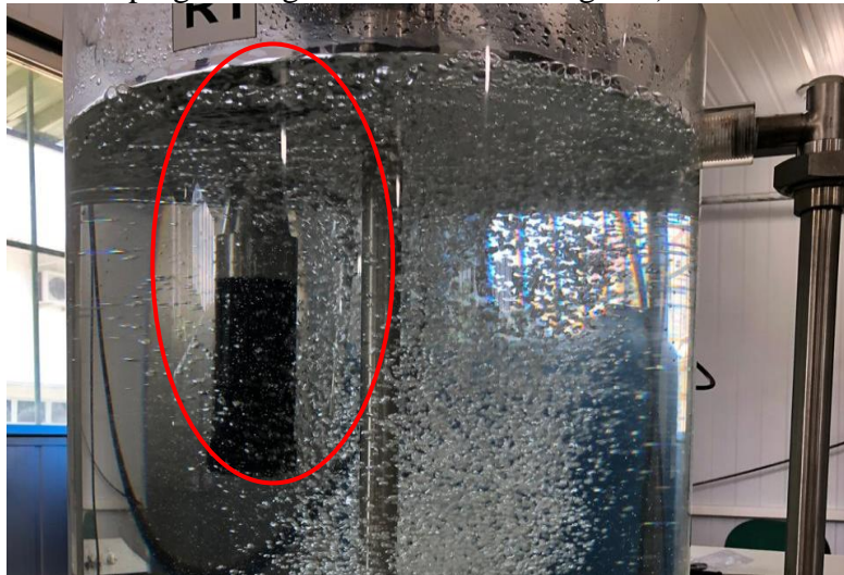
Figura 17 - Sensor de Oxigênio utilizado (Foto tirada durante teste do instrumento empregando água saturada com oxigênio)
