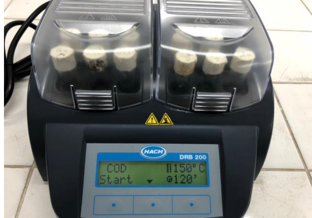
Figura 21 - Reator para DQO utilizado durante análise
