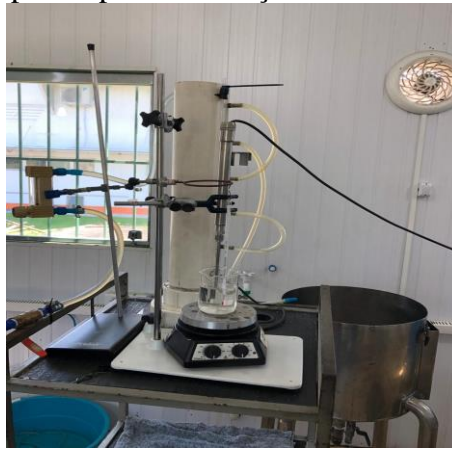
Figura 10 - Aparato para Calibração do sensor de temperatura
