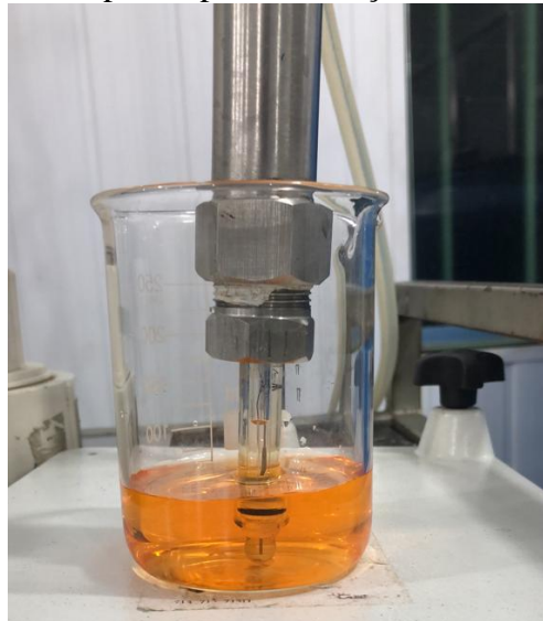
Figura 12 - Aparato para calibração do sensor de pH
