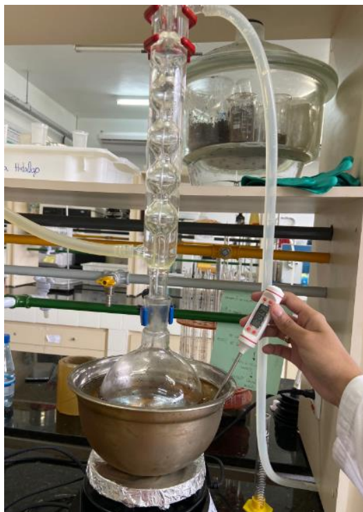
Figura 21 - Aparato experimental utilizado na reação de transesterificação
