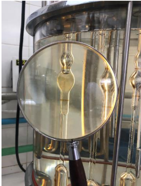
Figura 19 - Escoamento de amostra entre o primeiro menisco e o segundo.
