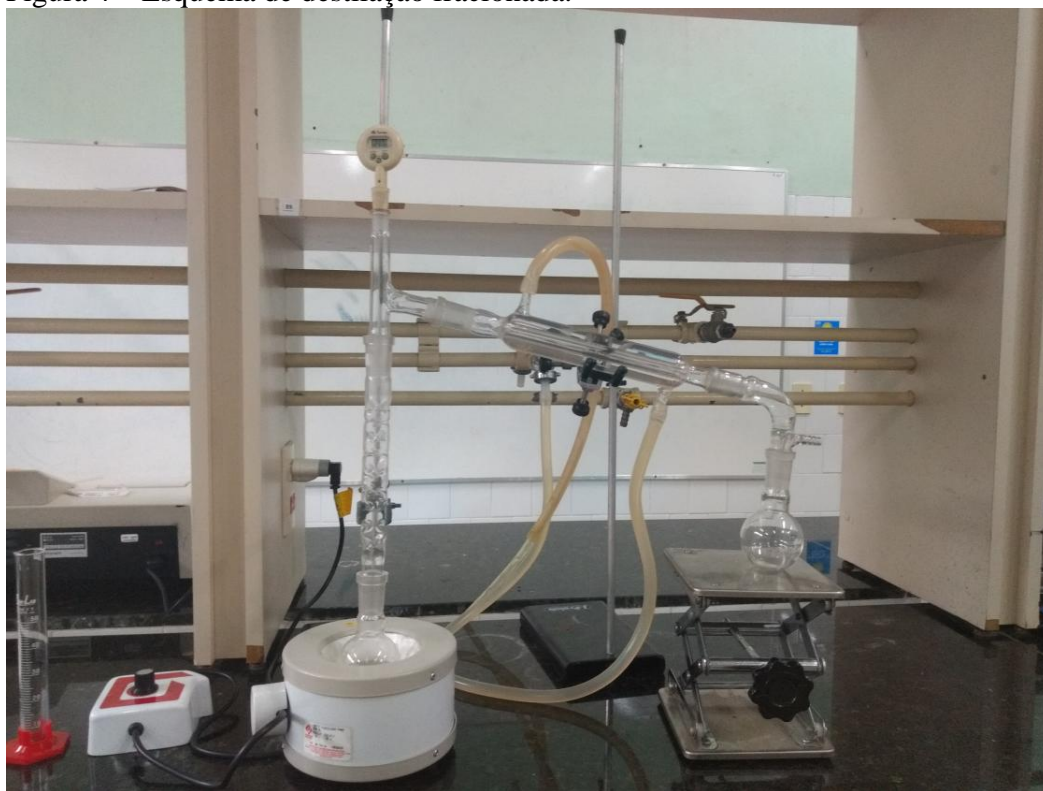
Figura 4 – Esquema de destilação fracionada.
