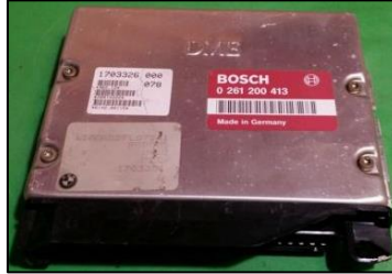
Figura 4.5 - Módulo de injeção original Bosch 0 261 200 413.
