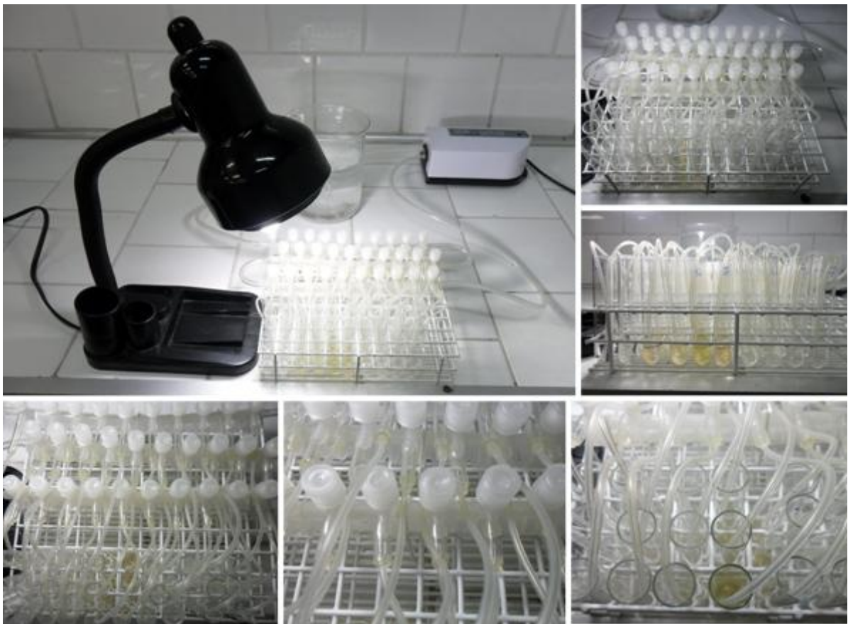
Figura 19. Sistema operacional para realização dos experimentos de citotoxicidade frente as larvas de Artemia salina .
