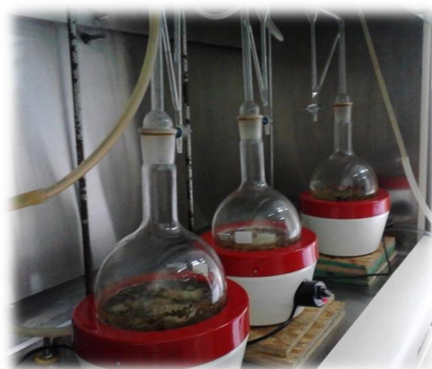
Figura 10. Extração de óleo essencial de folhas e galhos de A. canelilla em aparelho tipo Clevenger.
