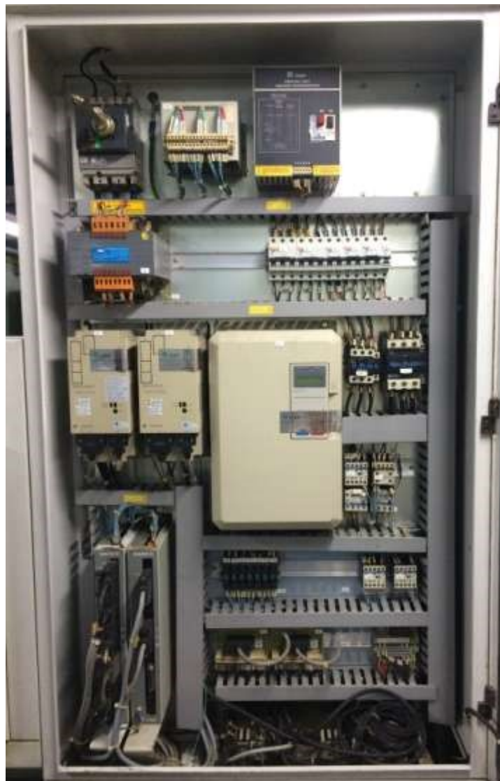
Figura 3 Comando numérico computadorizado do torno de CNC ROMI Centur 30D MACH 9. Fonte: do autor.
