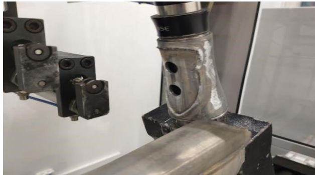
Imagem 34: Foto de falha do quadro 3
