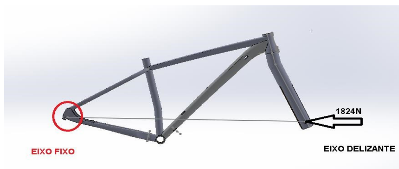
Imagem 12:Esquema de aplicação de carga para ensaio estático
