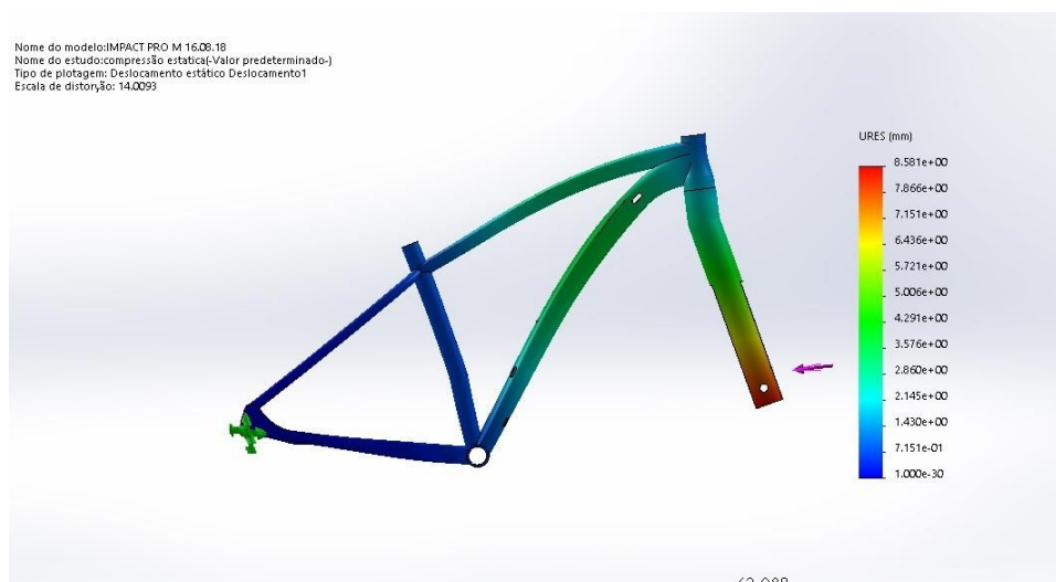
Imagem 21: Plotagem de deslocamentos em mm compressão estática
