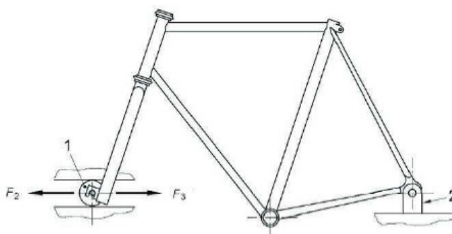
Imagem 14: Esquema de aplicação de carga para ensaio estático
