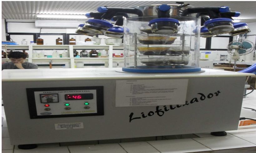
Figura 7 - Liofilizador em processo de desidratação do filtrado, para obtenção do extrato aquoso bruto. Foto: Machado, A.F. (2010).
