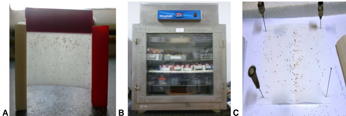
Figura 15 – A. Envelope contendo as larvas tratadas; B. condicionamento em estufa incubadora tipo B.O.D. a 27 \pm 1 °C e umidade relativa de 80 \pm 5 %; C. Contagem das larvas vivas e mortas. Fotos: Machado, A.F. (2011).
