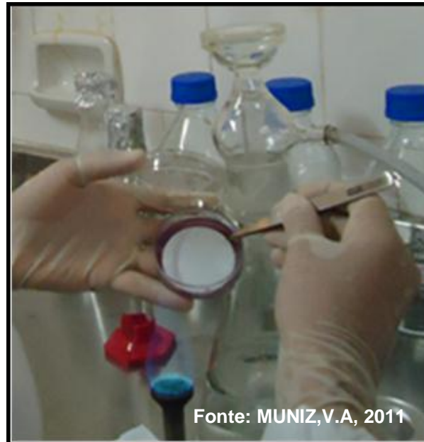
Figura 16: Transferência da membrana após filtração para placa de Petri contendo meio de cultura.
