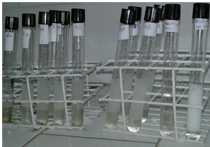
Figura 4 - Teste de índice de emulsificação com os meios metabólicos de endófitos de Piper hispidum .
