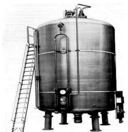
**Figura 8.** Vista geral de um acetificador em aço inoxidável Fonte: (MENEGUZZO; RIZZON, 2006).
