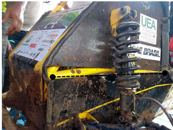
Figura 7 - Deformação na lateral esquerda da dianteira de um Mini Baja
