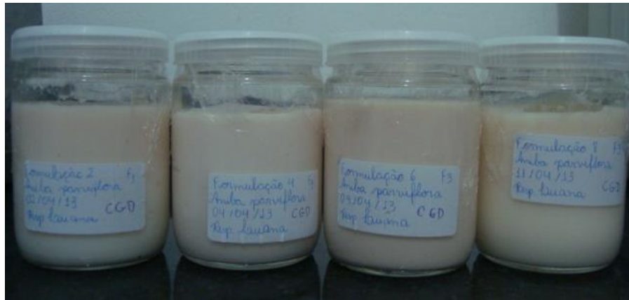
Figura 40 - Formulações F2, F4, F6 e F8 com variação de coloração após serem submetidas ao ciclo gela-degela.
