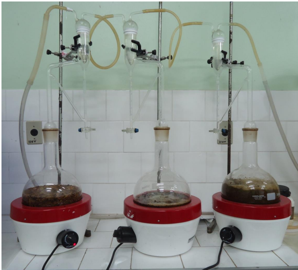
Figura 5 - Aparelhos tipo Clevenger utilizados para extração do óleo essencial de A. parviflora .
