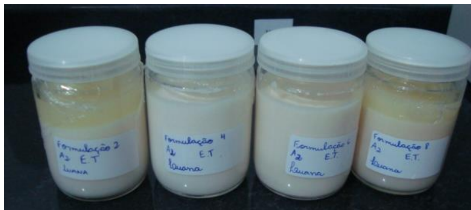
Figura 41 - Formulações F2, F4, F6 e F8 apresentando endurecimento da superfície após serem submetidas ao estresse térmico.
