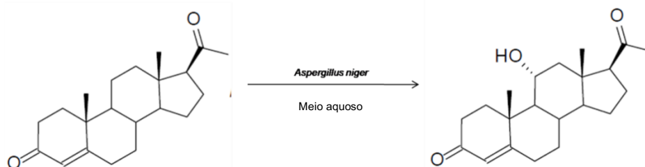
Figura 27 - Hidroxilação da progesterona mediada por Aspergillus niger .
