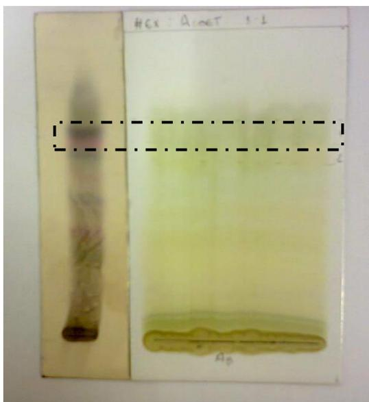
Figura 12. Isolamento de substâncias ativas por CCDP. A área demarcada indica a região que foi comparada, cortada e extraída para identificação.
