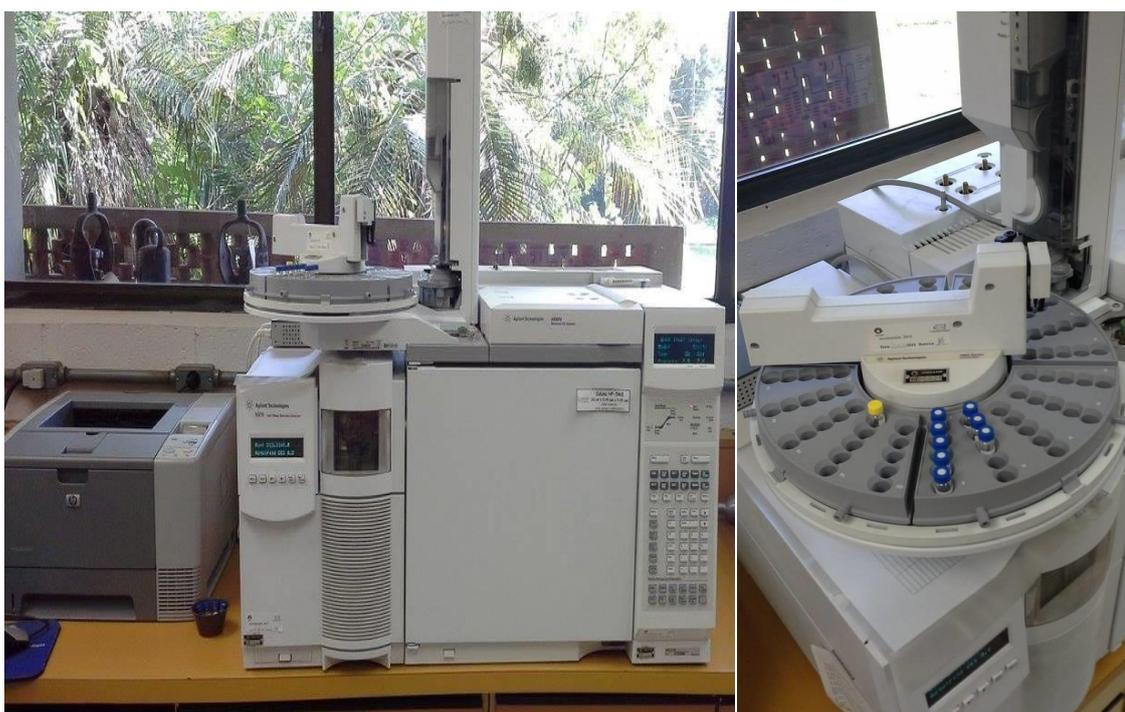
Figura 13. Cromatógrafo a gás Agilent modelo HP-6890 equipado com um detetor seletivo de massas Agilent modelo HP-5975 utilizado no trabalho.
