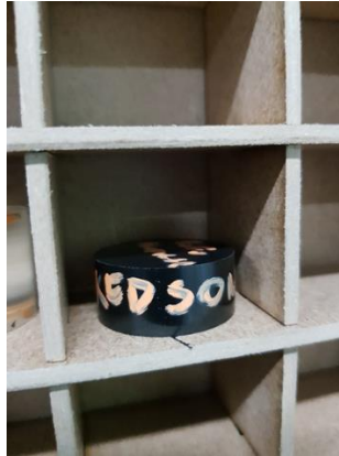
Figura 19 – Amostra do Embutimento do Ferro Fundido.
