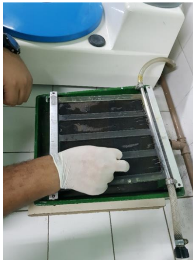
Figura 20 – Operação Manual do Lixamento.
