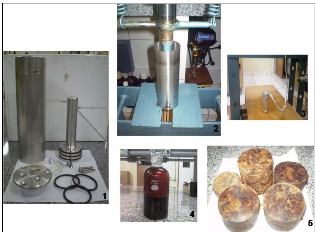
Figura 11- Extração do óleo da polpa seca do fruto de buriti por prensagem hidráulica. 1- peças de inox do cilindro de extração; 2- Extração do óleo com a polpa colocada no cilindro sob pressão de 10 toneladas; 3 - óleo de buriti sendo extraído em frasco volumétrico ao abrigo da luz e do ar; 4- óleo de buriti armazenado em frasco âmbar hermeticamente fechado. 5- torta resultante da polpa de buriti prensada.
