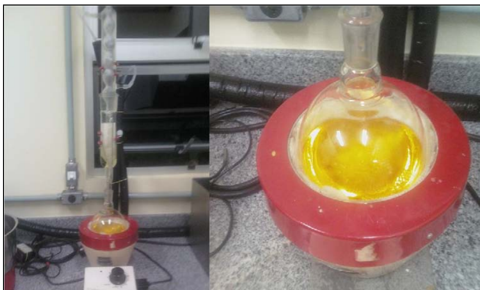
Figura 12- Processo de extração do óleo de buriti por solvente ( hexano) utilizando o aparelho o extrator Soxhlet. FONTE: Cecília Carvalho
