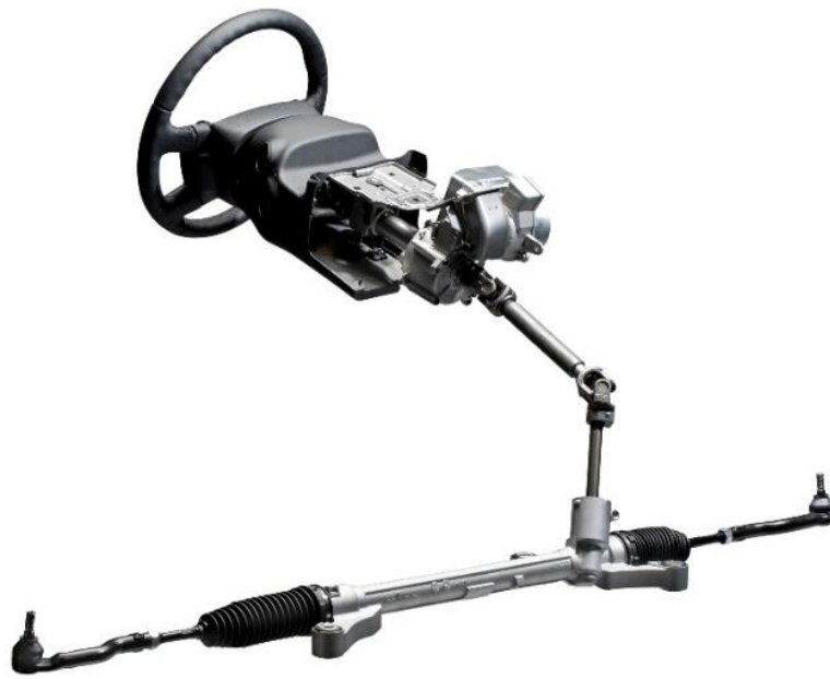
Figura 3 - Sistema de direção elétrica.
