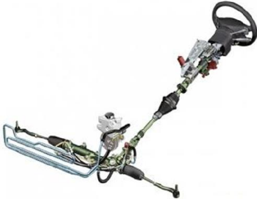
Figura 2 - Sistema de direção hidráulico.
