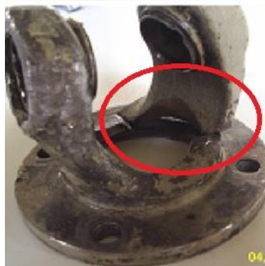
Figura 3. Falha ocorrida na base de uma junta Cardan.
