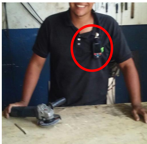
Figura 13–Dosímetro acoplado próximo ao ouvido
