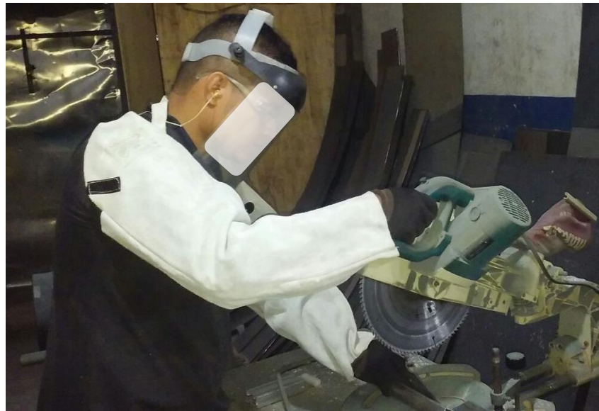
Figura 17– Operação com Serra elétrica policorte Makita LS1214
