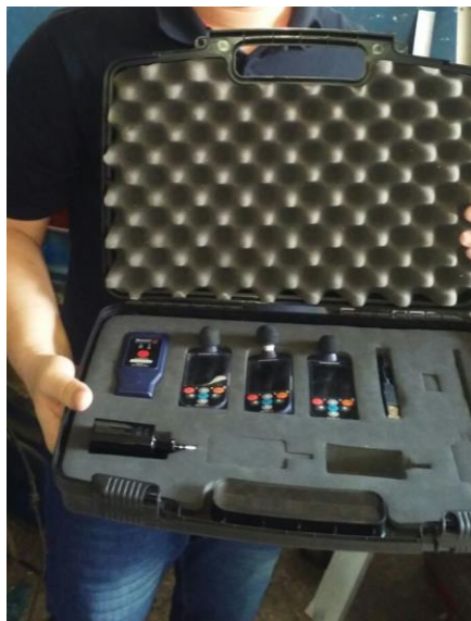
Figura 12– Equipamento Dosímetro smartdB Chrompack
