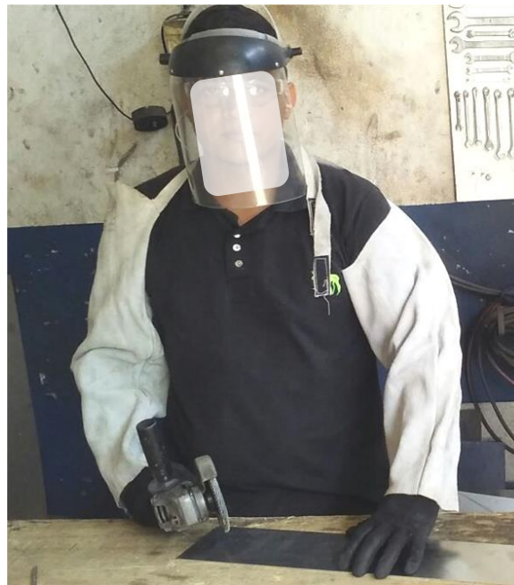
Figura 15– Operação com Lixadeira Angular Bosch M14 115 MM 127v
