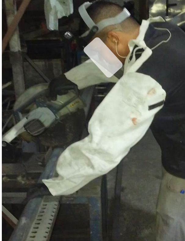
Figura 18– Operação com Serra elétrica policorte Bosch GCO 2000
