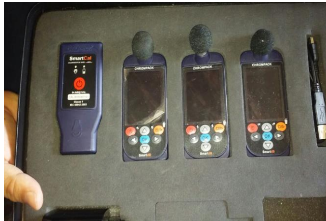
Figura 11– Equipamento Dosímetro smartdB Chrompack
