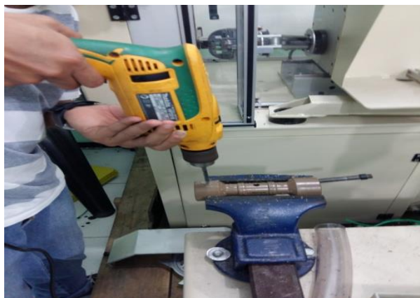
Figura 11 Construção do tubo de Venturi. Fonte: Autor (2017).
