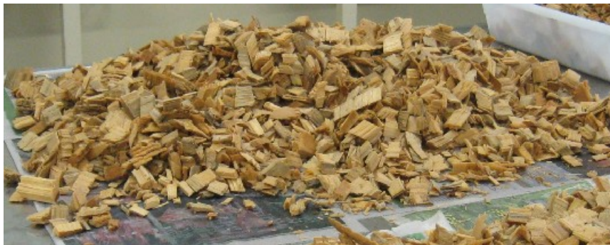
Figura 7: Cavacos de S. amara – Aubl. classificados e retidos nas malhas 1 ½ polegadas (40 e 60 MESH).
