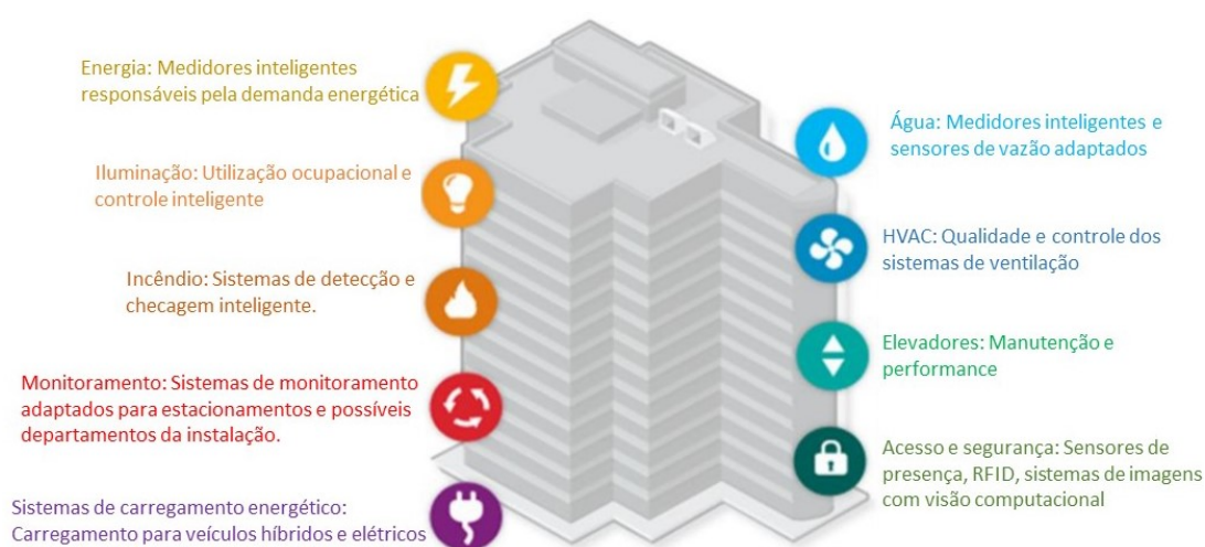
Figura 1 – Escopo estrutural do paradigma Smart Building .
