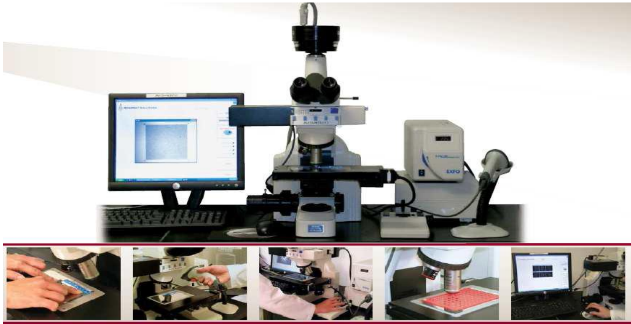
Figura 8. Sistema automatizado de captura e análise de dados AIS 400 (Array Imaging System). (49)
