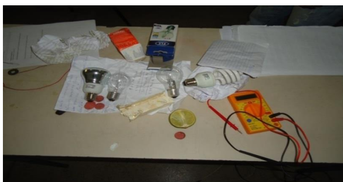
FIGURA 5- LÂMPADAS: INCANDESCENTE, HALOGÊNEA, FLORESCENTE E LED
