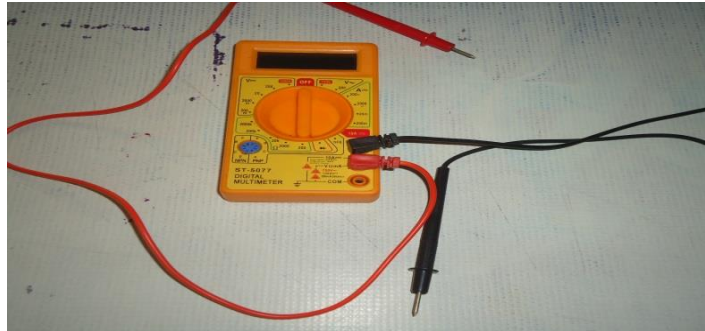
FIGURA 2- MULTÍMETRO UTILIZADO PARA MEDIR A VOLTAGEM DA PILHA
