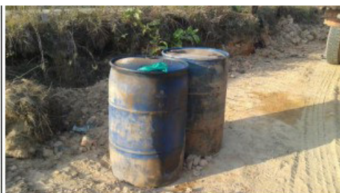
Armazenamento de combustível a céu aberto
