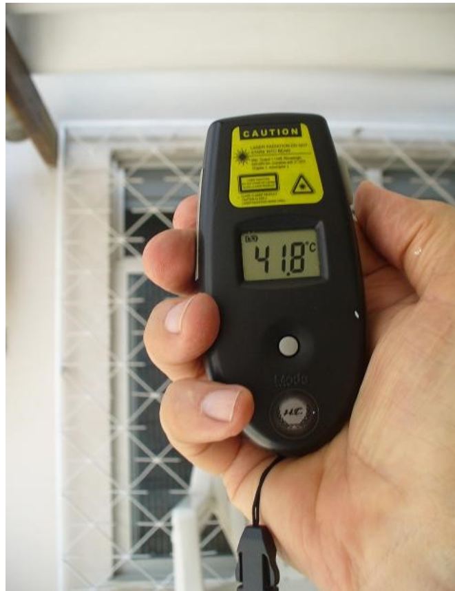
Figura 37 – Temperatura sob a telha pintada
