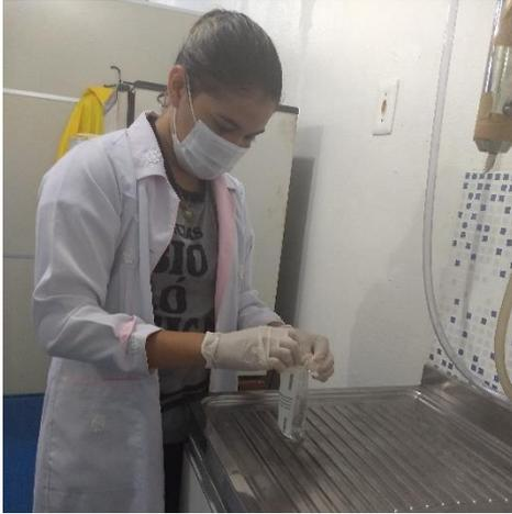
**Figura 4.** Adição do reagente colilert à amostra.
