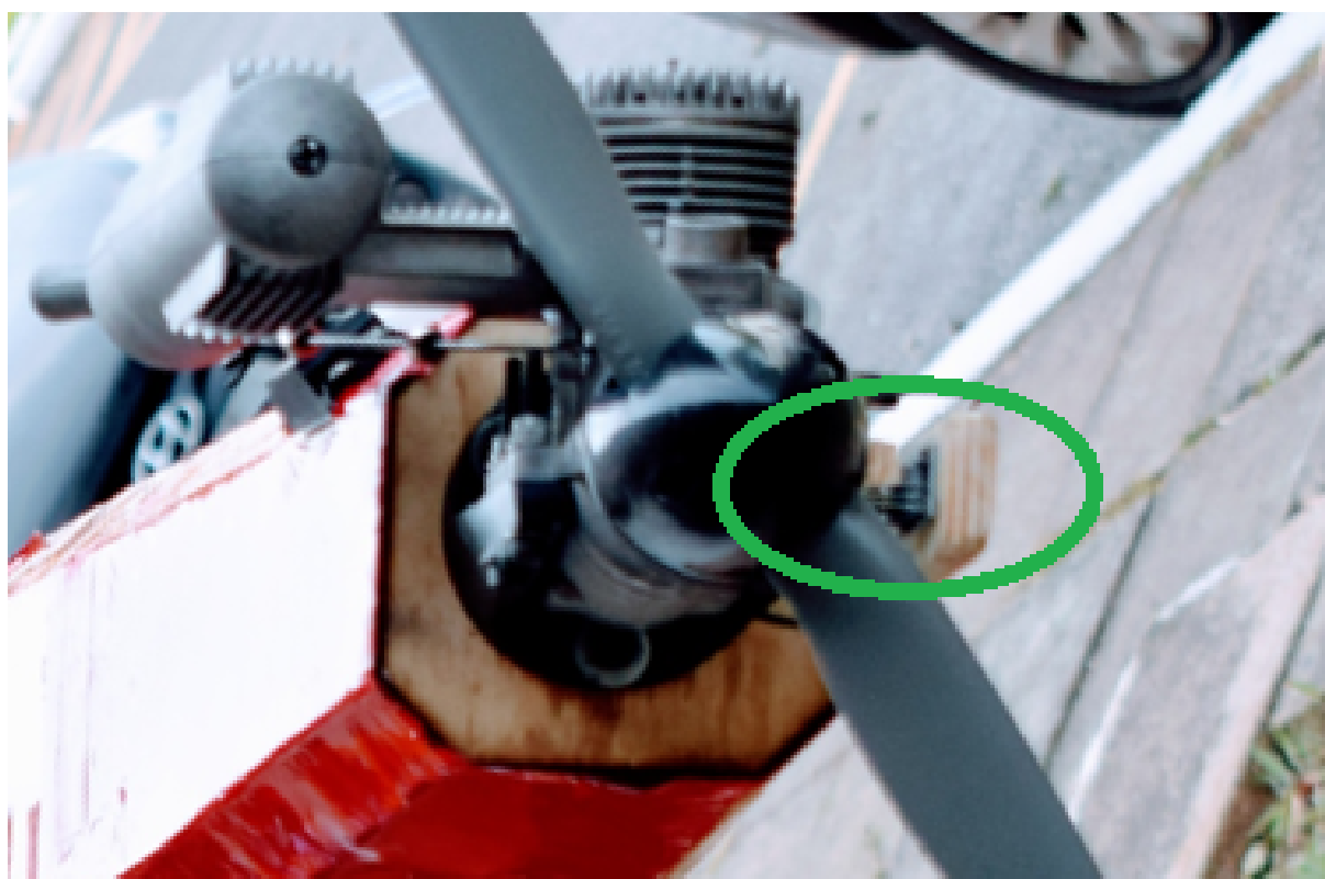
Figura 38 – Detalhe de instalação de sensor RPM
