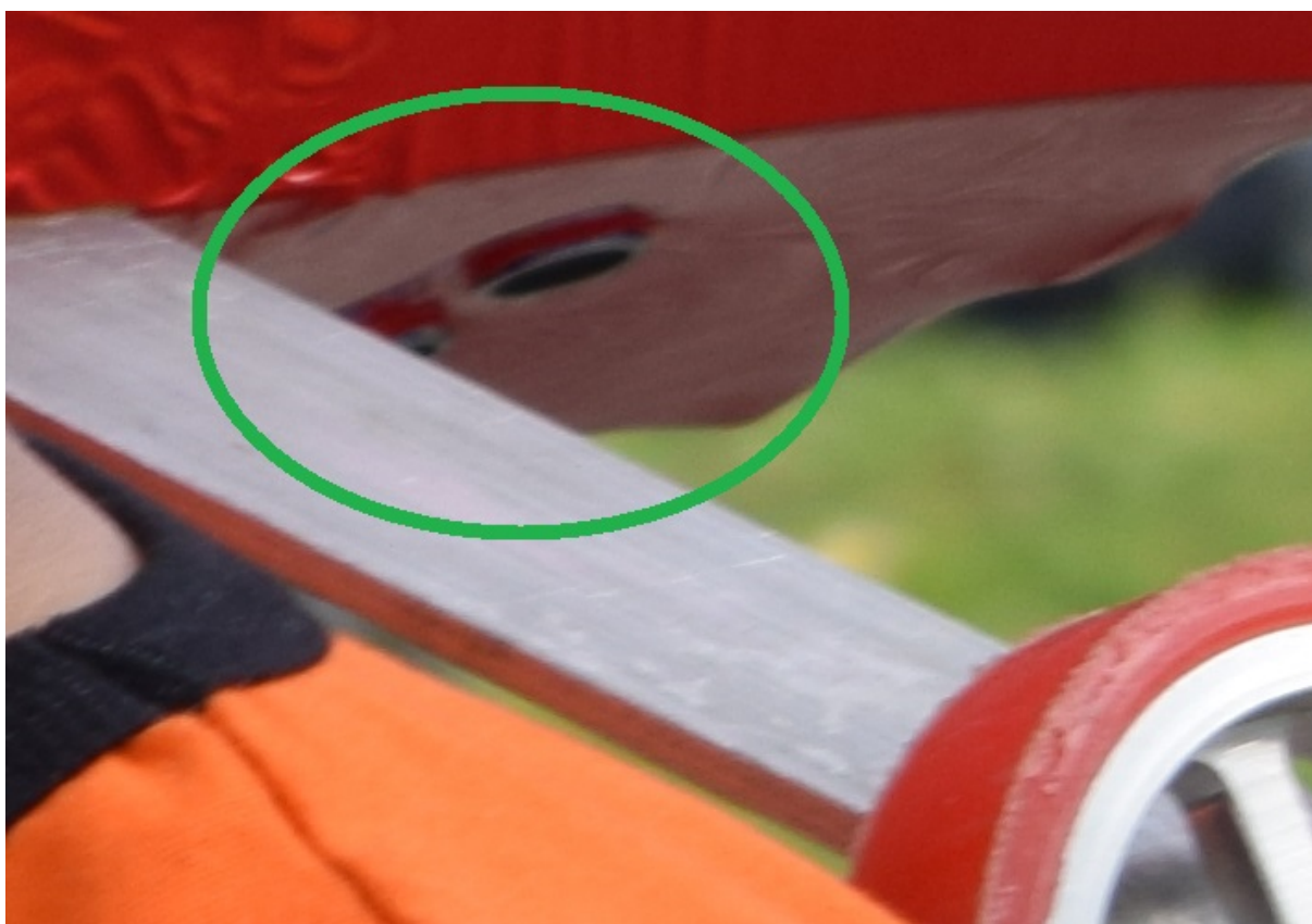
Figura 42 – Detalhe de instalação de sensor WOW
